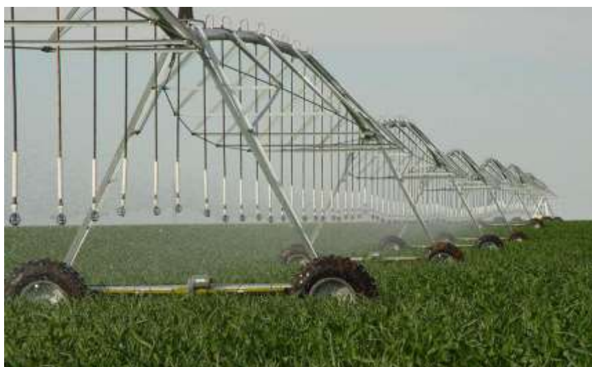
Impianto di irrigazione rainger (o pivot lineare)
